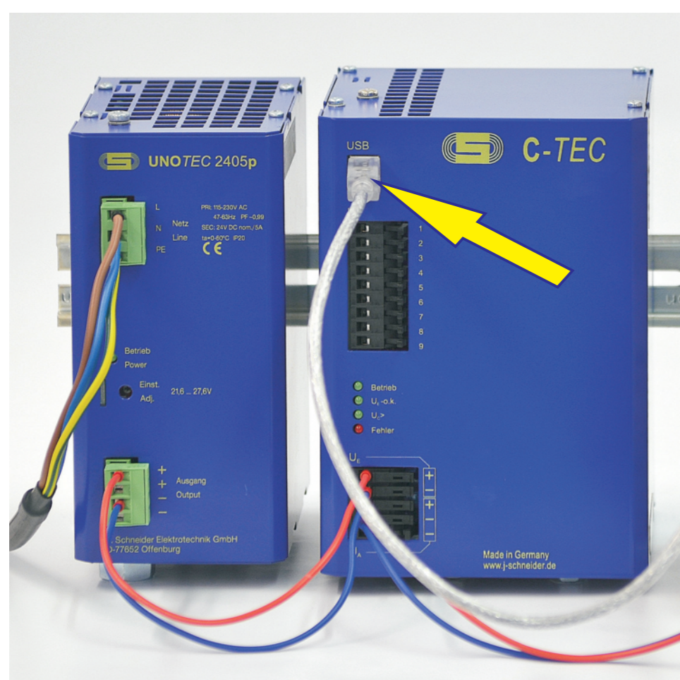
Anschluss der USB-Verbindung zum PC
