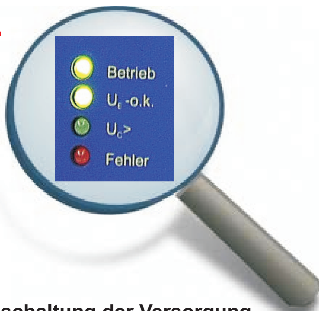
Zuschaltung der Versorgung. Das C-TEC wird geladen. Die LEDs „Betrieb“ und „U E ok“ leuchten
