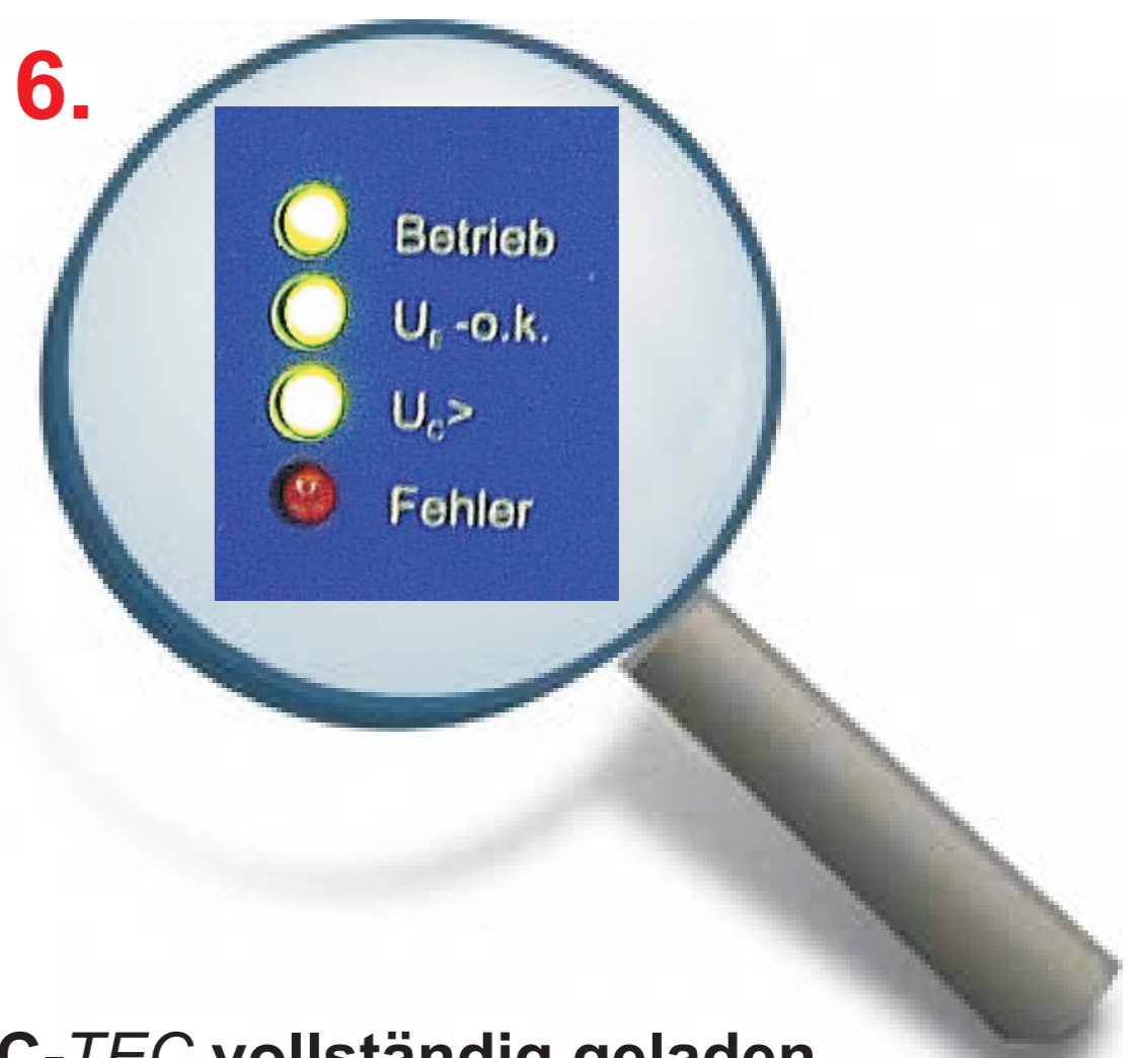
C-TEC vollständig geladen. Die LEDs „Betrieb“, „U E ok“ und „U C >“ leuchten
