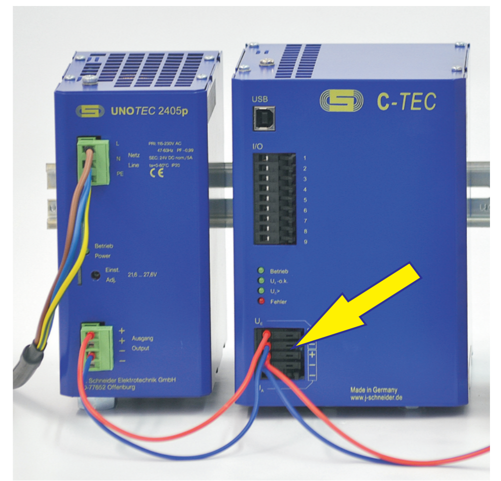
Anschluss der Last an den gepufferten 24VDC Ausgang des C-TEC
